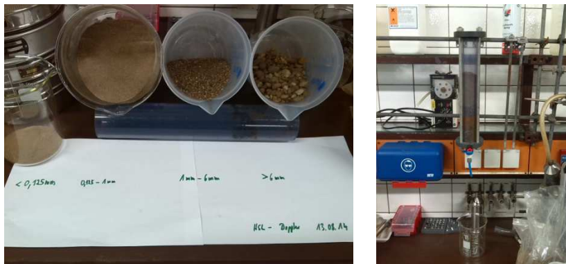
Abb. 1: Durchlässigkeitsversuche, HSL Karlsruhe 13.08.2014
